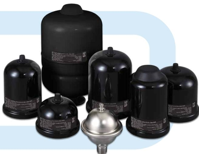
Les amortisseurs de choc HydroGuard™ sont spécialement conçus avec la dernière technologie de membrane conçue pour réduire et éliminer les chocs hydrauliques. Le diaphragme interne divise le parafoudre en chambres d'air et d'eau séparées. La chambre d'air scellée agit comme un coussin qui se comprime lorsque la pression de l'eau augmente soudainement, en raison d'un choc hydraulique.
